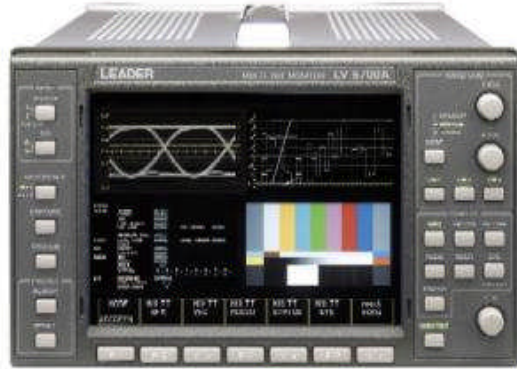
Resim 1.3: Hem Waveform hem de Vektörskop özelliđi bulunan bir cihaz
